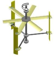
Gambar 2. Wells rotor dan turbin darrieus
